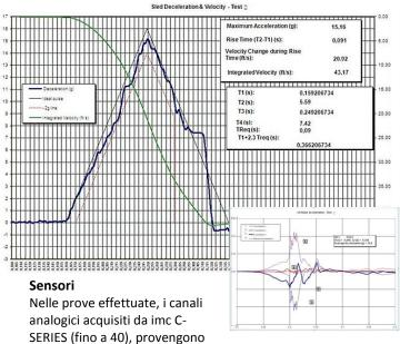
da accelerometri e celle di carico posizionati su testa, femore e bacino dei manichini oltre che sui sedili e sulla slitta stessa.
