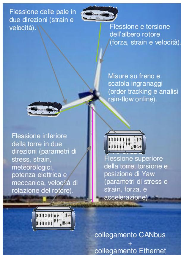
Esempio di misure strutturali e di carico su torre eolica. I sistemi **CANSAS** misurano parametri sulle pale e sull'albero rotore, i sistemi **CRONOS PL** sulla torre e la nacelle.
